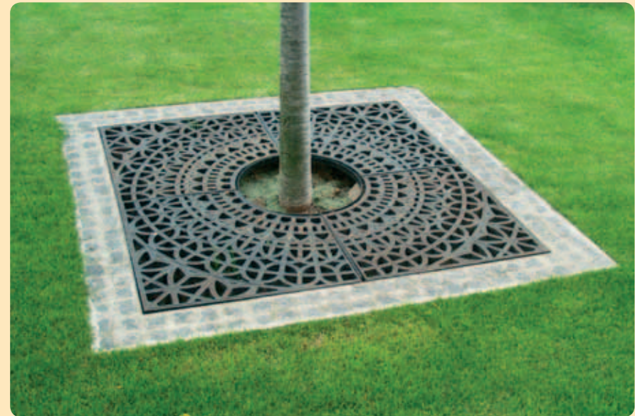
Baumscheibe eckig, in vier Segmenten gegossen Art. B3-1400500: Außenmaß: 1400x1400 mm, Innendurchmesser: 500 mm Art. B4-1400700: Außenmaß: 1400x1400 mm, Innendurchmesser: 700 mm
